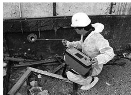
Рис. 1: Пример использования переносного анализатора паров ртути инспектором загрязненного участка
