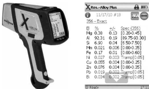
Рис. 2: Переносной рентгено – флуоресцентный анализатор Olympus Delta с изображением цифрового экрана считывания данных о металлах в полимере. Источник: www.innovx.com
